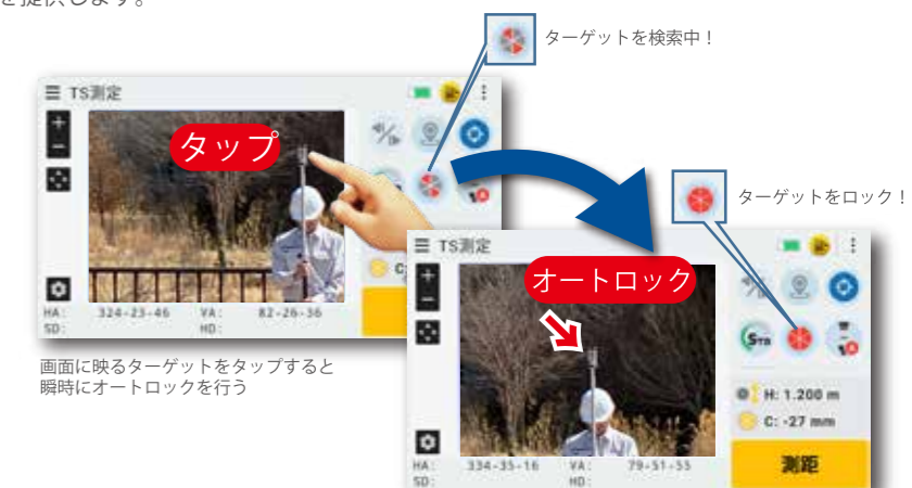
プリズムを補正するとターゲットを画面の中心に表示
