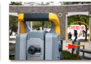
障害を通過した後もTrimble Sシリーズはプリズムをすばやくキャッチ (一瞬ロストするが即座に追尾開始)
