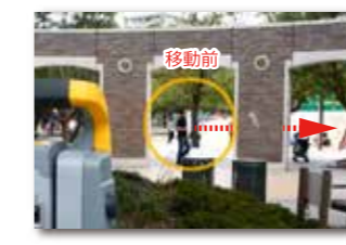
Trimble Sシリーズが途中で障害の有る壁の向こう側のプリズムを追尾中
