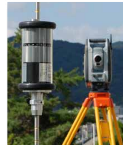
アクティブターゲットを捉える Trimble S7
